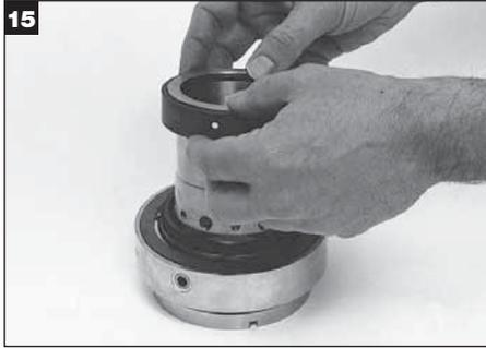
15 Limpie las caras de la estacionaria y de la rotativa con un trapo limpio sin pelusa. Coloque la brida del cubo, con la estacionaria instalada hacia arriba, sobre una superficie plana. Coloque la junta del frente de la caja en la brida del cubo.
