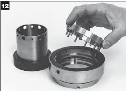
Coloque el conjunto de la brida del cubo, con la junta hacia arriba, sobre una superficie plana. Lubrique el aro tórico estático e instálelo en la brida del cubo. Alinee las ranuras del impulsor de la estacionaria con las orejas en la brida del cubo. Deslice e introduzca el impulsor de la estacionaria hasta que los resortes toquen la brida del cubo. Coloque la arandela de soporte en la brida del cubo.
