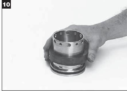
Deslice la rotativa sobre la camisa, alineando las orejas de arrastre con las ranuras de la rotativa. Deslice la rotativa sobre el aro tórico hasta el fondo. Asegúrese de que las orejas de arrastre estén bien enganchadas.
