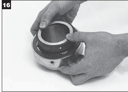
16 Deslice la camisa, con la rotativa instalada hacia abajo, dentro de la brida del cubo. Levante la brida del cubo y la camisa y continúe presionando juntándolas hasta que sus frentes entren en contacto.
