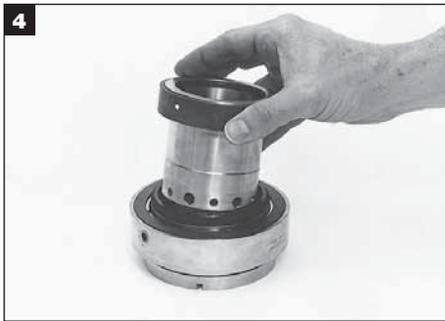
Sujetando la camisa y la brida juntas, voltee el conjunto del sello y saque la rotativa y la camisa, separando con los dedos la cara de la estacionaria de la cara de la rotativa.
