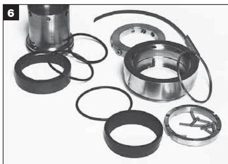
Quite la arandela de soporte y el impulsor de la estacionaria con los resortes. Quite los resortes del impulsor de la estacionaria. Saque de la camisa: la rotativa, el aro tórico de la rotativa y el aro tórico del eje.
