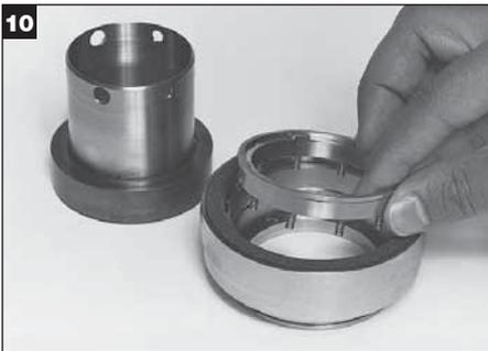
Coloque el conjunto de la brida del cubo sobre una superficie plana con el lado de la junta hacia arriba. Alinee las ranuras del impulsor de la estacionaria con las orejas en la brida del cubo. Deslice e introduzca el impulsor de la estacionaria hasta que los resortes toquen la brida del cubo. Coloque la arandela de soporte en la brida del cubo. La arandela descansará sobre el impulsor de la estacionaria hasta que el sello sea comprimido.
