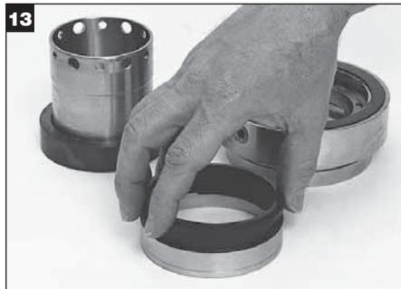
Lubrique el aro tórico (O-Ring) dinámico para la estacionaria y deslícelo dentro de la ranura en el diámetro interior del adaptador. Coloque la estacionaria cara abajo sobre una superficie plana y presione el adaptador sobre la estacionaria.
