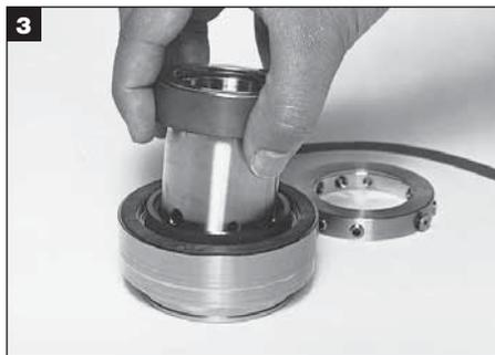
Sujetando la camisa y la brida juntas, voltee el conjunto del sello y saque la rotativa y la camisa, separando con los dedos la cara de la estacionaria de la cara de la rotativa. Si se hace difícil separar las caras, gírelas en sentidos opuestos.
