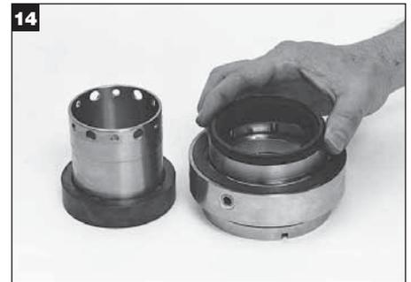
Deslice el conjunto de la estacionaria y adaptador dentro de la brida del cubo hasta que enganche con el impulsor de la estacionaria. Asegúrese de alinear las orejas de arrastre con las ranuras de la estacionaria.
