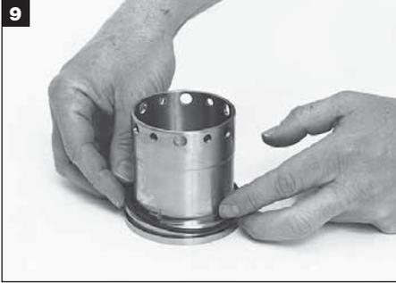
Lubrique al aro tórico (O-Ring) del diámetro interior de la camisa con la grasa de silicona suministrada e instálelo en la ranura del diámetro interior de la camisa. Lubrique el aro tórico de la rotativa e instálelo en la ranura del diámetro exterior de la camisa.
