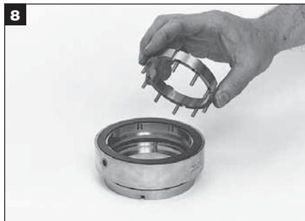
Saque el impulsor de la estacionaria con los resortes. Quite el aro tórico estático del interior de la brida del cubo. Saque los resortes del impulsor de la estacionaria.
