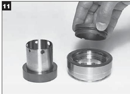
Lubrique el aro tórico (O-Ring) dinámico para la estacionaria. Deslice el aro tórico sobre la estacionaria. Deslice la estacionaria dentro de la brida del cubo hasta que enganche con el impulsor de la estacionaria. Asegúrese de alinear las orejas de arrastre con las ranuras de la estacionaria.
