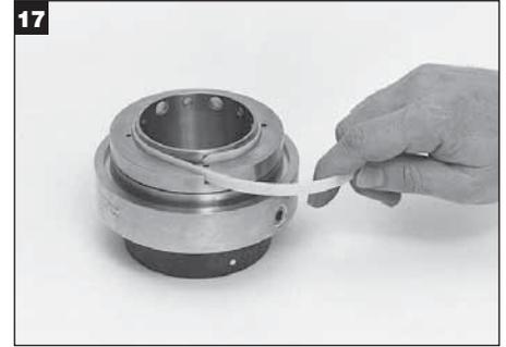
17 Presione por la brida del cubo hacia abajo y empuje la cinta centradora por la ranura en la brida del cubo. Empuje la cinta hasta que rodee completamente la camisa del sello. La cinta se guiará entre la brida del cubo, camisa del sello y anillo de fijación.
