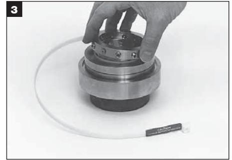
Coloque el sello, con el anillo de fijación hacia arriba, sobre una superficie plana. Retroceda todos los tornillos de la camisa. Quite el anillo de fijación y la cinta centradora.
