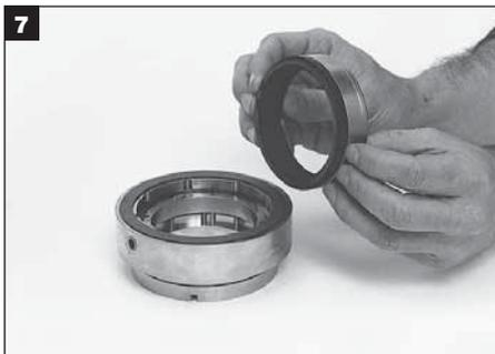
Quite la estacionaria y el adaptador juntos. Sepárelos y saque el aro tórico dinámico.
