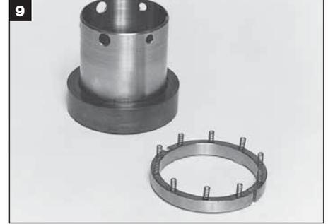
Coloque un resorte en cada orificio del impulsor de la estacionaria. Puede aplicarse un poco de grasa de silicona a la parte inferior de cada resorte. Esto ayudará a que los resortes permanezcan en los orificios.
